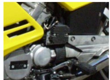
Wenn man die Kabel des Reglers verlängert, kann dieser eigentlich an jeden Ort verlegt werden. Wie zum Beispiel an die Gabel oder unter den Motor.
