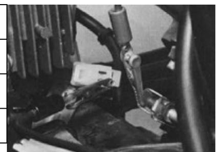
Ist kein Durchgang zwischen den Anschlüssen untereinander, oder besteht Durchgang zwischen einem der Anschlüsse und Masse, ist eine Unterbrechung bzw. ein Kurzschluss in der Statorwicklung.
