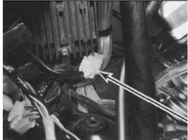
Mit Hilfe eines Ohmmeters (bevorzugt) oder einer Prüflampe den Durchgang zwischen jedem der 3 Kabel vom Stator prüfen. Durchgang sollte zwischen jedem der 3 Kabel bestehen (Yamaha gibt einen Widerstand von  $0,32 \pm 10\% \Omega$  an)
